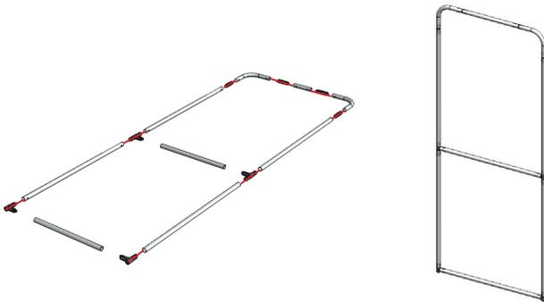
Connecter les tubes de la base en suivant le repérage par numéro
