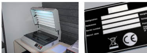
Marquage aluminium photosensible (Procédé métal photo®)
